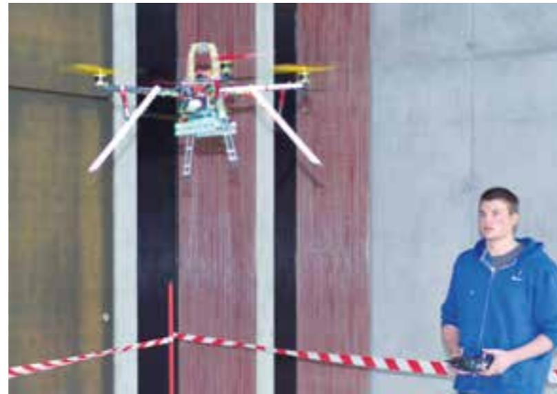
Automatiker-Projekt: Drohne mit Navigation und Kamera.
