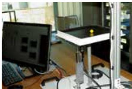
Der Computer wertet ein Kamerabild aus und ermöglicht es, die Kugel über einen im Voraus definierbaren Weg von einem Punkt A zu einem anderen Punkt B zu bewegen. Er regelt dazu den in zwei Achsen beweglichen Tisch.
